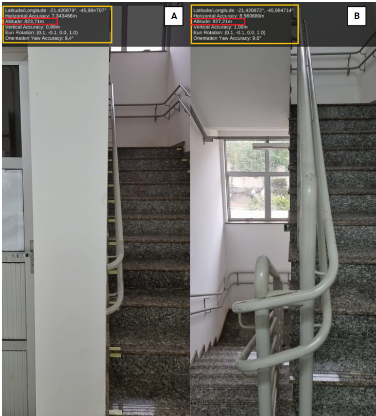
Figura 4: A altitude mantém-se relativamente estável, mesmo em ambientes internos. A: Andar térreo. Latitude/Longitude: -21,420879°, -45,984707°. Altitude: 823,71 m; B: Primeiro andar. Latitude/Longitude: -21,420872°, -45,984714°. Altitude: 827,21 m.
