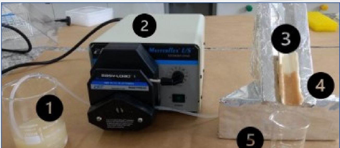
Aparato para determinação da retenção de formulações em mucosa. (1) Muco artificial, (2) Bomba peristáltica, (3) Tubo plástico, (4) Substrato: ágar ou mucosa excisada, (5) Frasco coletor (Naves et al, 2028)
