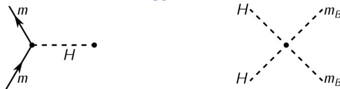
Figura 11: Vértices de acoplamento entre as partículas no modelo eletrofraco de S. Weinberg
