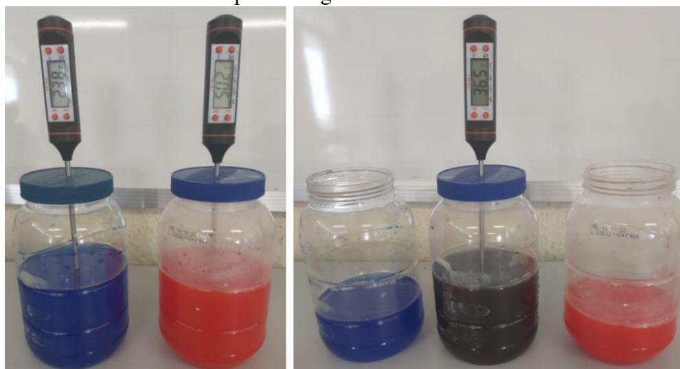
Figura 3 – Equilíbrio Térmico – (a) Fluidos em temperaturas distintas (b) Equilíbrio térmico após homogeneizar os fluidos
