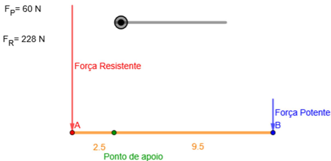
Figura 14: Sistema de alavanca interfixa - Posição 2.
