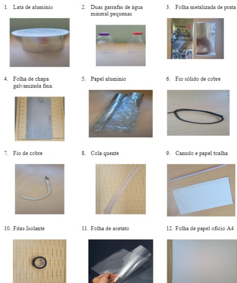
Figura 2 – Materiais para construção do aparato experimental - materiais de 1 a 12.
