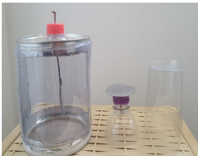
Figura 54 – Aparato experimental - Eletroscópio de folhas.
