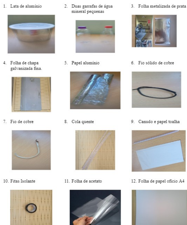
Figura 46 – Materiais para construção do aparato experimental - materiais de 1 a 12.
