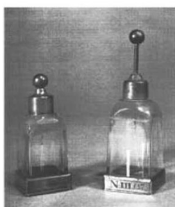
Figura 14 – Eletroscópio de folhas de ouro de Bennet (MEDEIROS, 2002).
