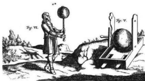
Figura 6 – A máquina eletrostática desenvolvida por Guericke (1672).
