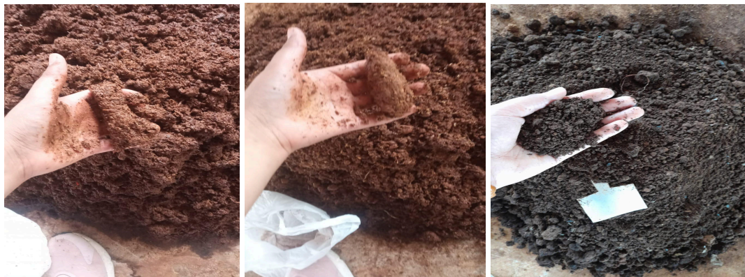
Figura 5 – Execução do teste rápido para verificar nível de umidade do composto
