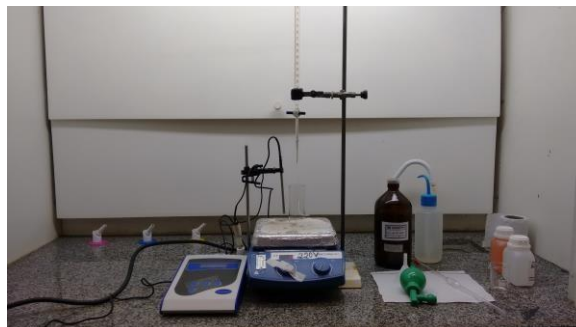
Figura 2: Titulação Potenciométrica de HCl
