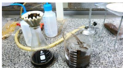
Figura 1: Processo de Filtração.
